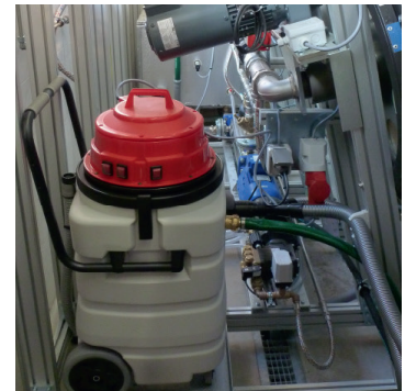
3 traps natzuiger met ingebouwde dompelpomp voor automatische lediging
