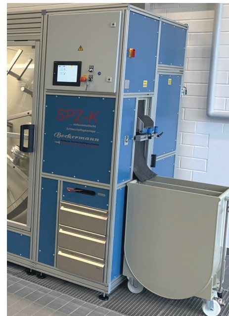
3 vaks schuifladenblok in de SPZ-K geïntegreerd
