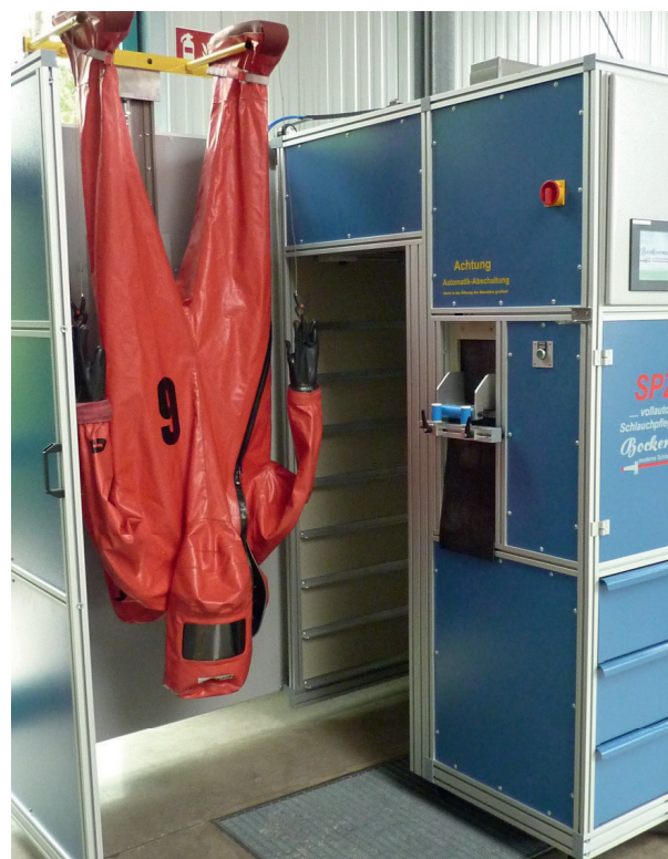
Pneumatisch gestuurde hijsinrichting voor het pak
