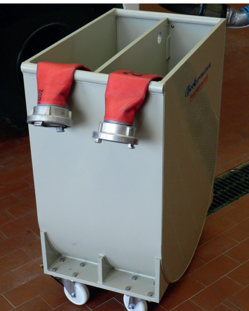
Voorweekreservoir met tussenschot en affaatkraan van bovenaf bedienbaar
