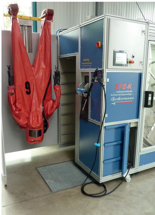
Hogedruk reinigingspistool met drukregelaar en automatisch slangoprolsysteem
