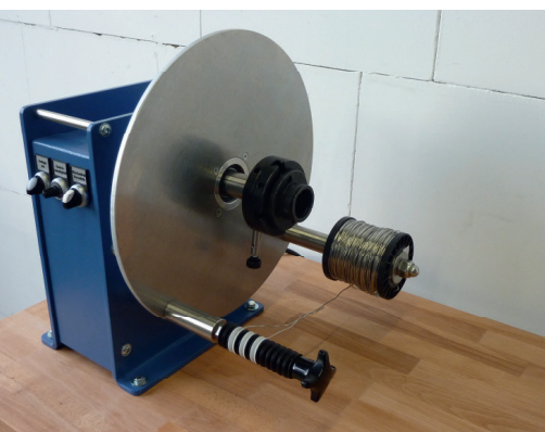
Electrische slangbendelmachine met uittrekbare inrichting, plaatsbesparend in de SPZ-K geïntegreerd
