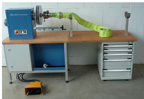
SEM-E 455 WBC modèle complet avec extension d'établi et bloc-tiroirs
