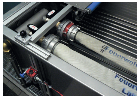
(Testspruitstuk met vergrendelbare aansluitingen, ontluchtingsspruitstuk en verschuifbare V2A-overdrachtsplaat)
