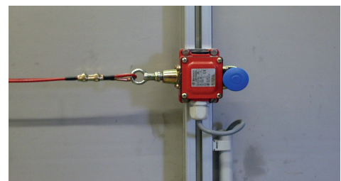
Noodstop scheurkoord volgens EU-machinerichtlijn
